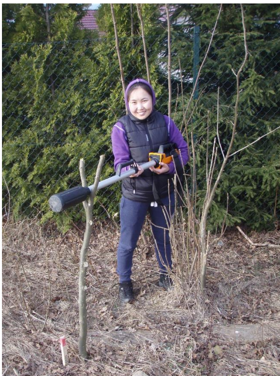
Obr.3. Měření radioaktivity gamaspektrometrií GT-32T v terénu. Foto: Viktor Goliáš
