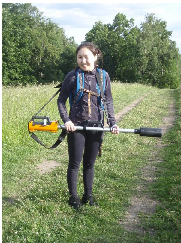
Obr.6. Měření radioaktivity gamaspektrometrií GT-32T v terénu. Foto: Viktor Goliáš.
